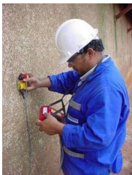
Figura 5 – Ensaio de Pacometria (Autores do trabalho, 2015).
