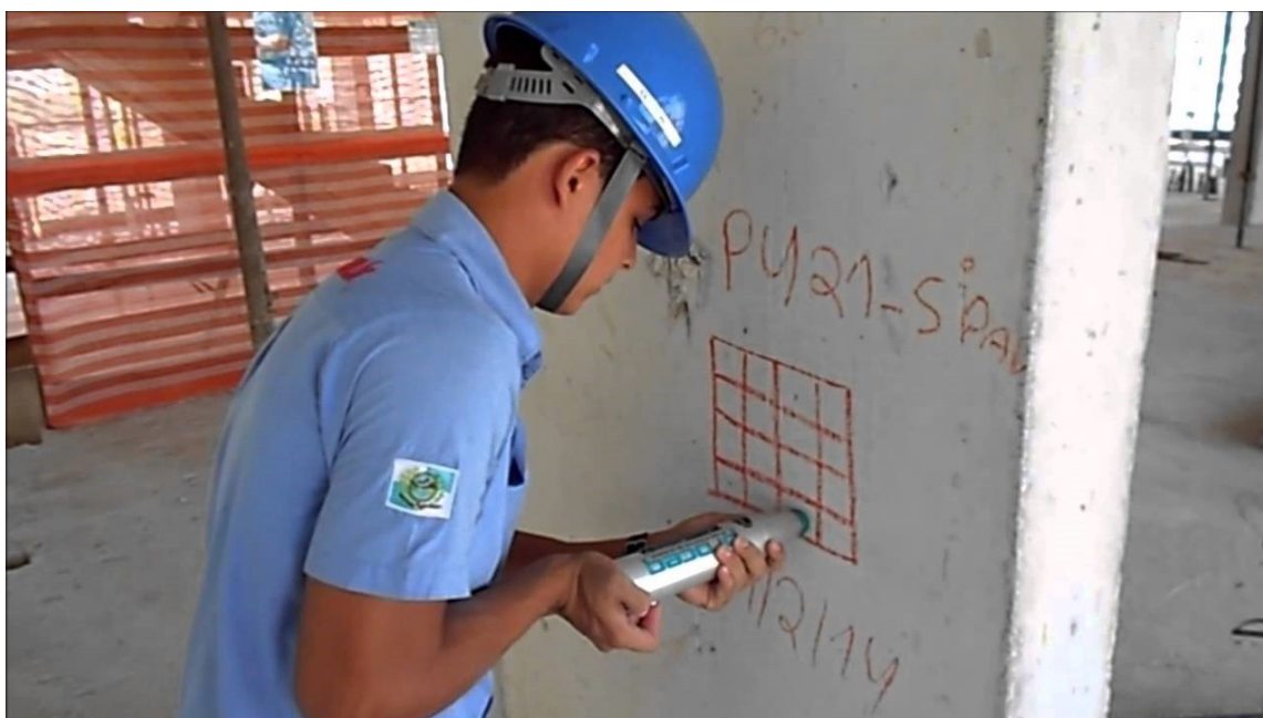
Figura 3 - Ensaio de esclerometria (Autores do trabalho, 2015).
