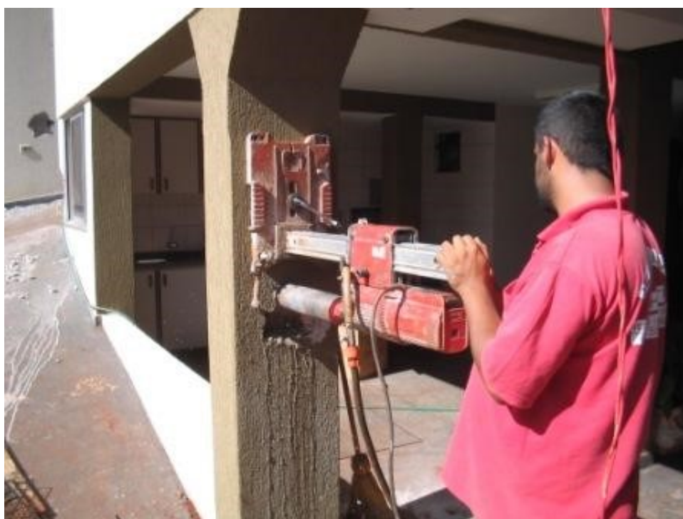
Figura 6 – Extração corpos de prova (Autores do trabalho, 2015)
