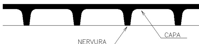
Figura 10. Detalhe genérico estrutural
